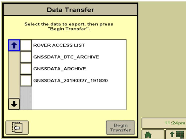
**Captura de datos de prioridad mediana:** El receptor StarFire™ 6000 ahora le brinda al usuario la alternativa de capturar datos sobre determinados DTC. Cuando se activan los DTC siguientes: GR6 DTC 523348.16 y 523348.07, se muestra una alternativa en la máscara de alarma para activar la captura de datos.
